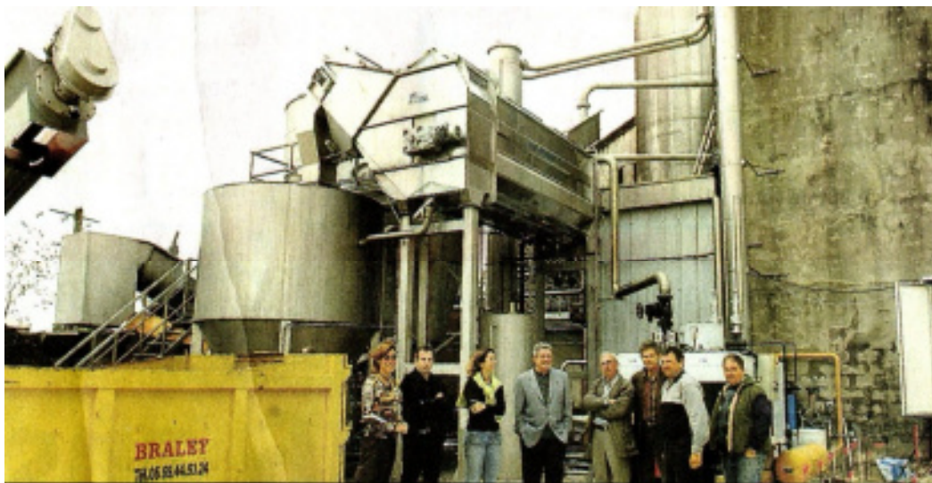
Thermovinification et flash détente : la nouvelle œnologie au service de vins ciblés à l'exportation. Photo PS
